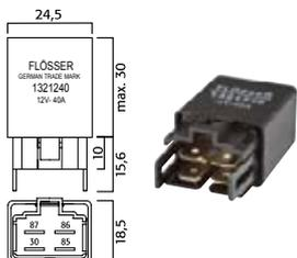
Schließer mit 5 Anschlüssen · Normally open relays with 5 terminals
